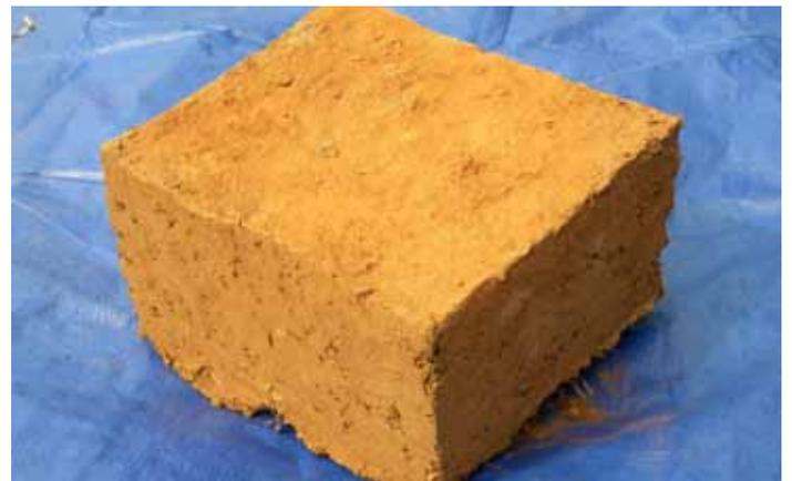
contrées sur place nous avons rempli plusieurs sacs avec les copeaux. Faire des briques avec les copeaux est vraiment agréable et facile. Le mélange se prépare rapidement et le démoulage se passe assez bien. Aucune brique n'a fissuré, les ADOBES tiennent bien la forme et enfin avec une importante proportion de morceaux de bois la brique devient plus légère. Le seul point négatif est qu'il faut payer les copeaux.
