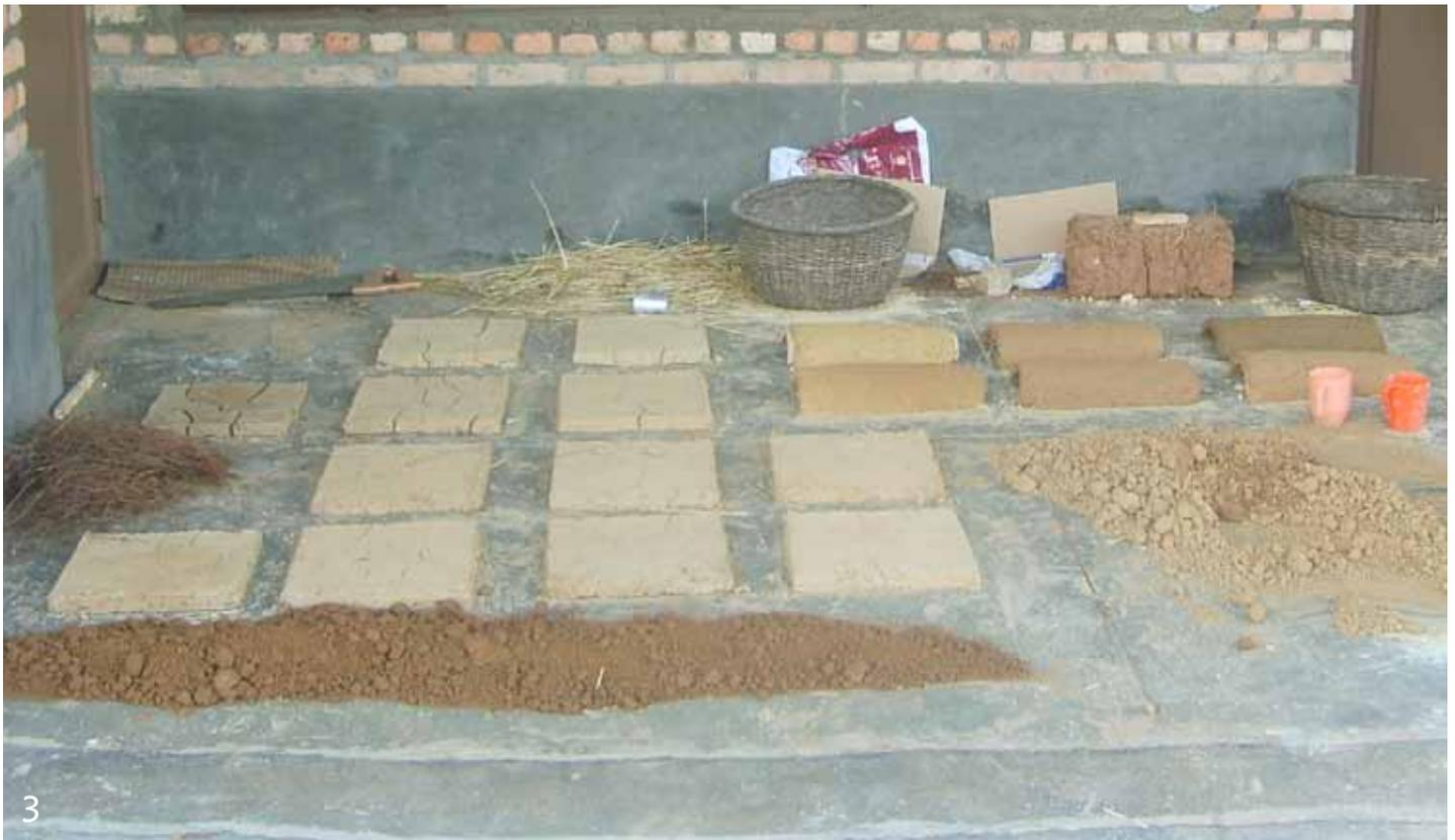
La terre M, pour être utilisée a besoin de beaucoup de sable pour éviter la fissuration (1 volume de terre, 3 volume de sable et des fibres (paille)). En mélangeant la terre M avec la terre B nous avons déjà constaté une amélioration du comportement (moins de fissures).
